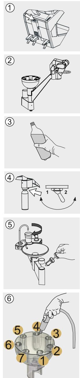
7. Turbinenanschluss mit aufgesetzter Unifix (Multiflexkupplung) aus der Parkposition (ohne aufgesetztes Übertragungsinstrument) nehmen und im CleanHub positionieren. Sicherstellen, dass die Wasserregulierung an der Unifix (Multiflexkupplung) geöffnet ist. (Position 3-7)
