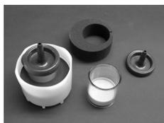
Damit der handelsübliche Becher in das Gerät eingesetzt werden kann, wird in einen Mischbecher gross der Becher-Einsatz zum handelsüblichen Becher eingesetzt. Der handelsübliche Becher wird in den Becher mit Einsatz eingefügt und als Ganzes in den Becherträger des Gerätes zum Mischen eingesetzt.
