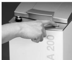
Starttaste drücken. Nach dem Mischprozess stellt das Gerät automatisch ab.
